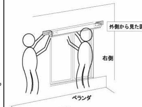
① ロールスクリーン本体の裏側に組込まれている「裏板」をスライドさせ取付金具の穴と合わせ、本体固定ネジ(付属部品⑤)を止めます。
