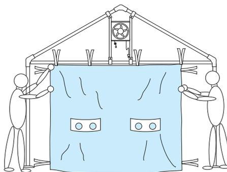
PCR検査ブースの上部、下部にあるリボンをフレームに結わいて固定していきます。
