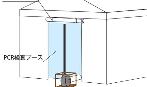
PCR検査ブースへ送風を行う場合（送風機をご使用の場合）、感染症対策テントの背面出入口は開けた状態でご使用下さい。またご使用時は送風機に雨除けカバーを付けて下さい。
